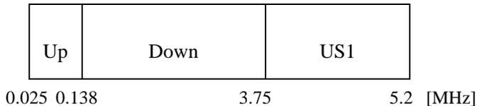
図1 US1バンドを用いたADSLバンドプランの例
