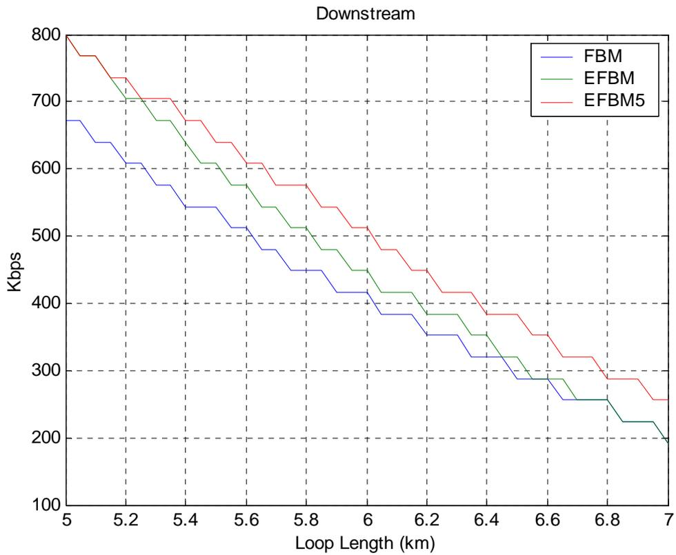
Figure 3: 同一カードを含む24 TCM-ISDN 干渉源からの漏話環境下での下り速度
