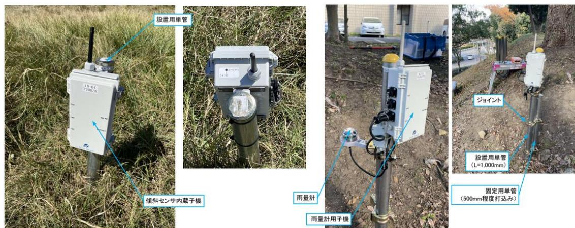
図 2.9-3. 機材の設置イメージ
