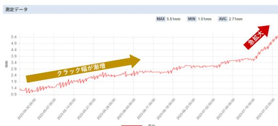
図 2.7-9. 法面のひび割れ拡大を確認
