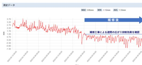
図 2.7-10. 橋梁補修工事の効果を確認
