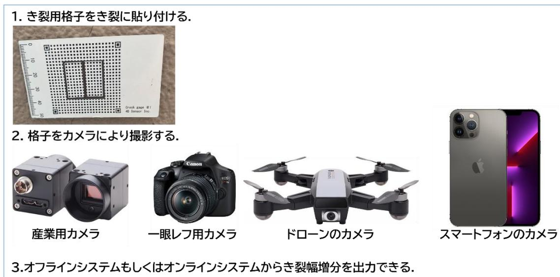
図 2.5-4. 本事例の計測作業フロー
