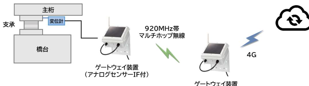
図 2.1-1. 無線伝送型の変位計による支承変位量モニタリングの概要
