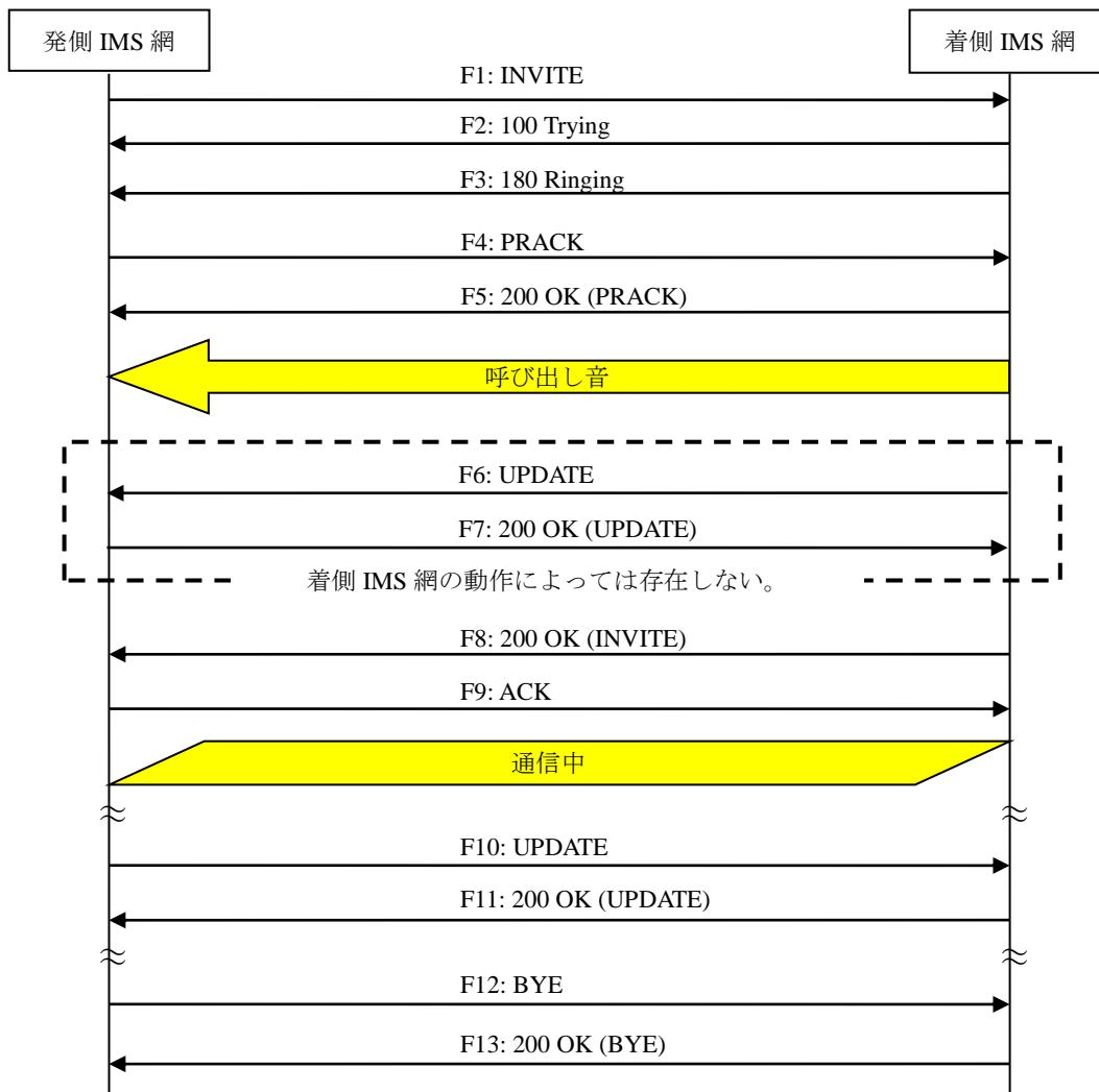
付図 vii.2.1.1.3-1/JJ-90.30 基本接続（発側切断）
