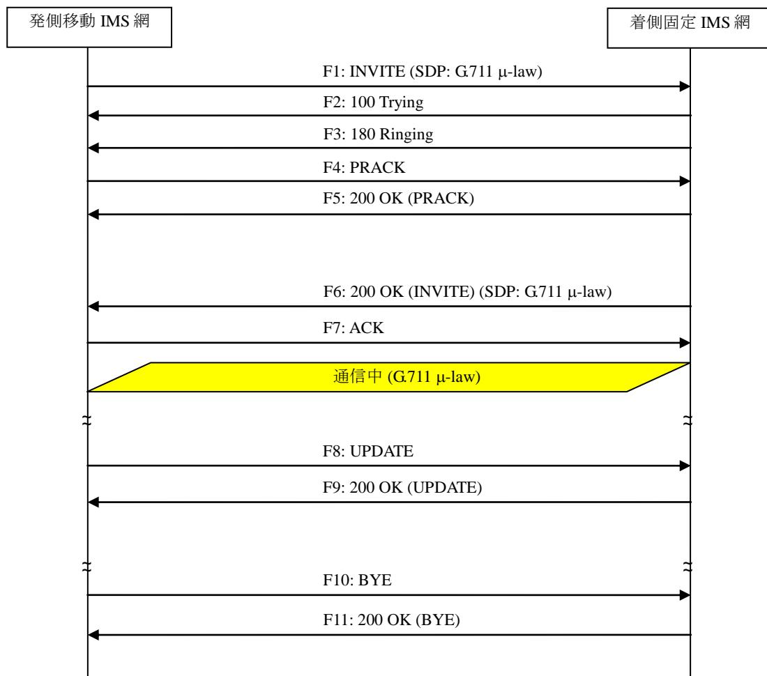
付図 vii.2.1.4-1/JJ-90.30 基本接続（発側切断）
