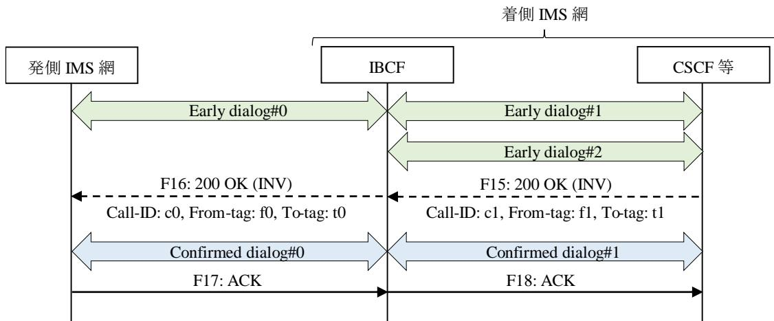
付図 vi.2.3-5/JJ-90.30 Initial INVITE リクエストに対する SDP アンサーを含まない 200 (OK) レスポンス受信時の動作
