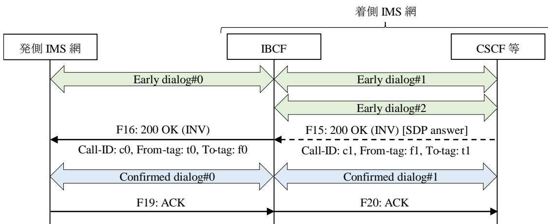
付図 vi.2.3-3 / JJ-90.30 Initial INVITE リクエストに対する SDP アンサーを含む 200 (OK) レスポンス受信時の動作
