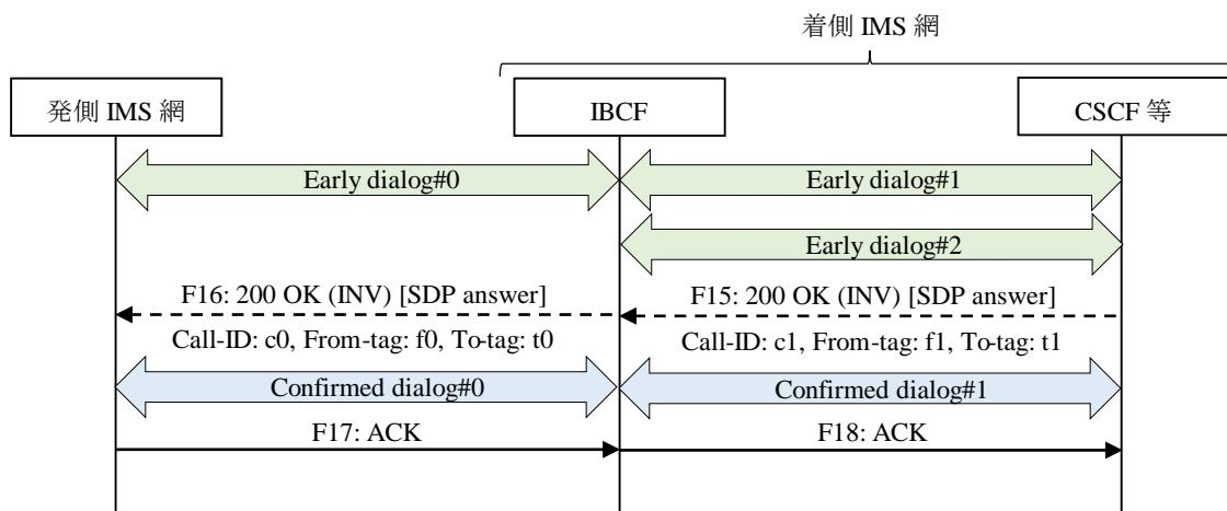
付図 vi.2.3-1/JJ-90.30 Initial INVITE リクエストに対する SDP アンサーを含む 200 (OK) レスポンス受信時の動作
