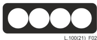
図2 典型的なカプセル形光ファイバリボンの断面図
