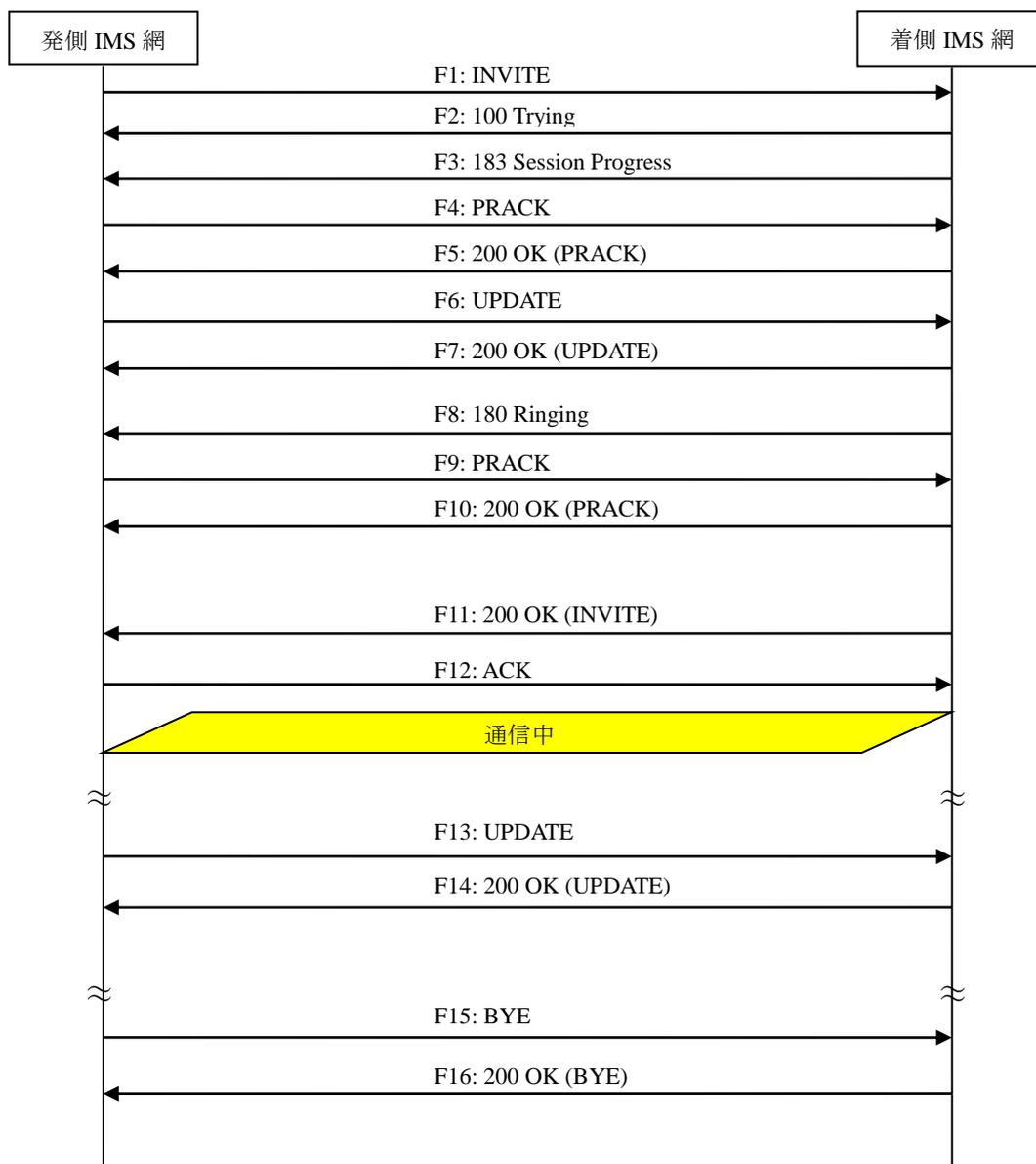
付図 vii.2.1.2.1-1/JJ-90.30 基本接続 (発側切断)
