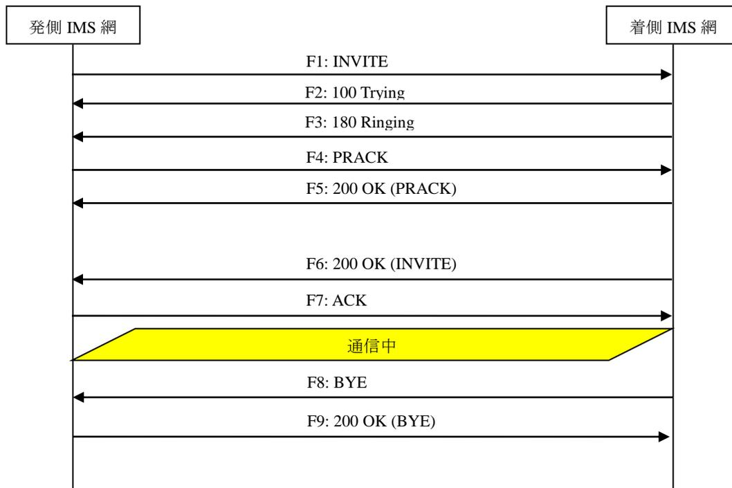
付図 vii.2.2-1/JJ-90.30 基本接続（着側切断）
