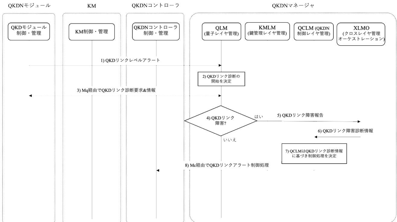
図 2. 障害管理手順の一例：QKDリンク障害
