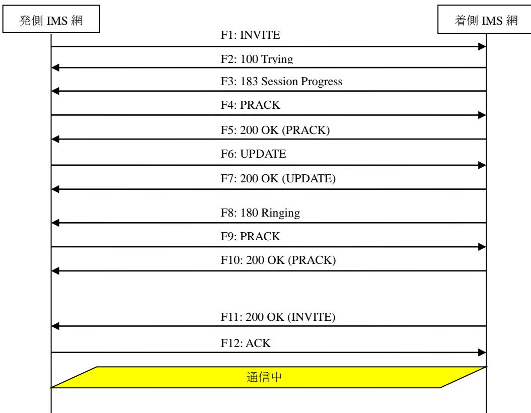
付図 vii.2.1.2.2-1／JJ-90.30 基本接続（発側切断）
