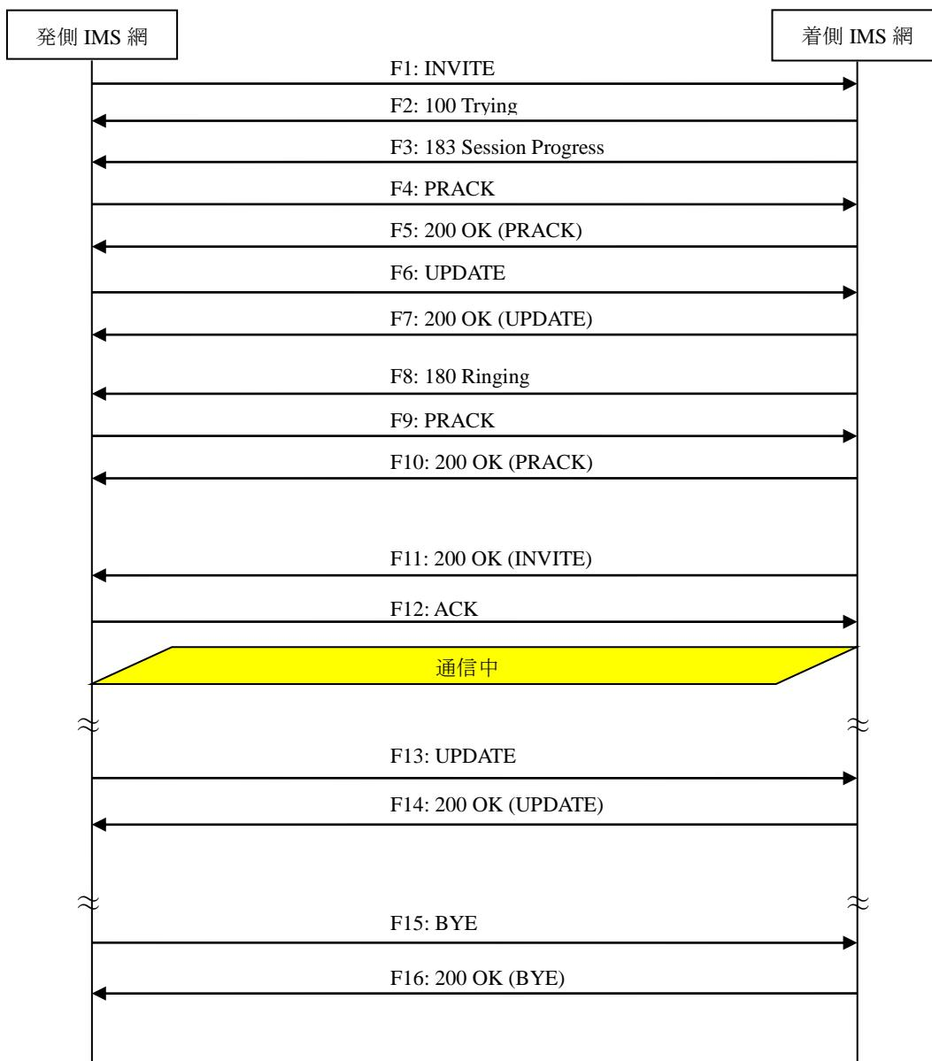
付図 vii.2.1.2.1-1／JJ-90.30 基本接続（発側切断）
