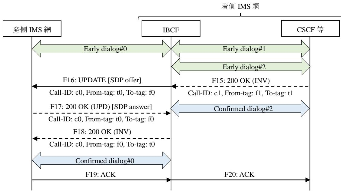
付図 vi.2.3-4/JJ-90.30 Initial INVITE リクエストに対する SDP アンサーを含まない 200 (OK) レスポンス受信時の動作
