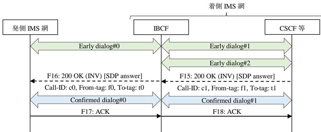
付図 vi.2.3-1/JJ-90.30 Initial INVITE リクエストに対する SDP アンサーを含む 200 (OK) レスポンス受信時の動作
