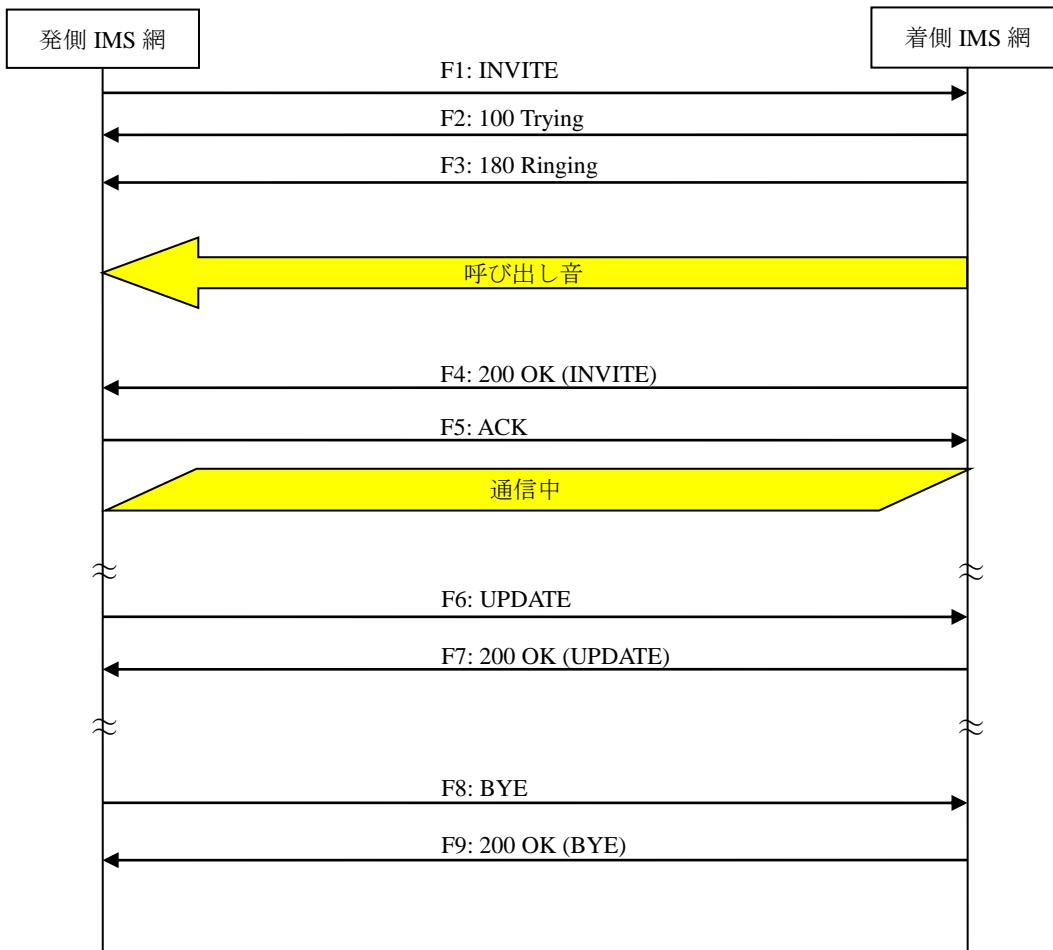
付図 vii.2.1.1.2-1/JJ-90.30 基本接続（発側切断）
