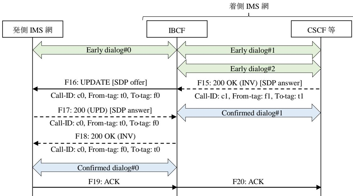
付図 vi.2.3-2/JJ-90.30 Initial INVITE リクエストに対する SDP アンサーを含む 200 (OK) レスポンス受信時の動作
