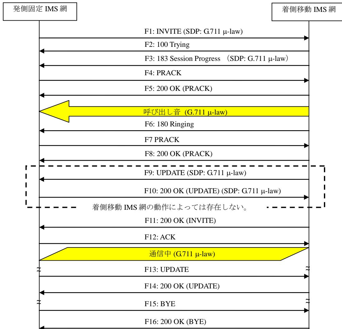
付図 vii.2.1.3-1/JJ-90.30 基本接続（発側切断）
