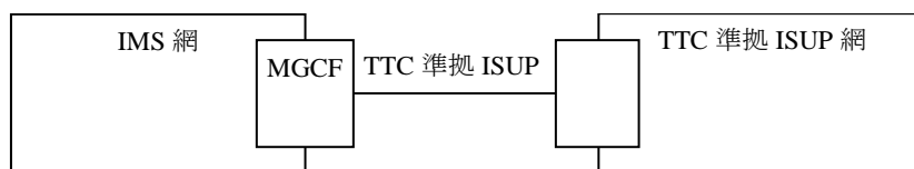
付図 ii.2.2-1/JJ-90.30 IMS 網-TTC ISUP 網相互接続モデル
