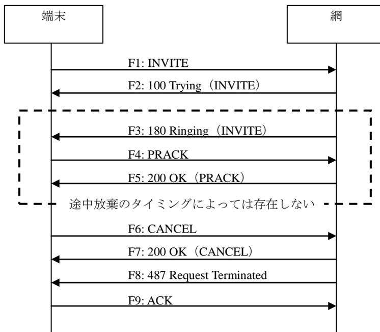
付図 7-7/JT-Q3402 途中放棄（呼び出し中切断）
