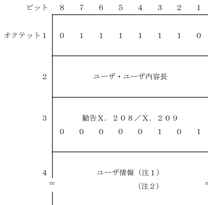
図4-5/JT-Q957補遺 プロトコル識別子=「勧告X. 208/X. 209 (ASN. 1)」のコーディング例
