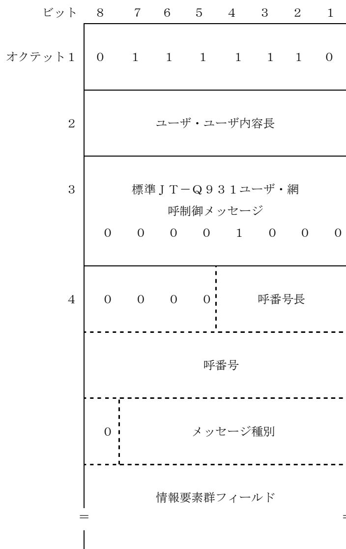
図4-11/JT-Q957補遺 プロトコル識別子=「標準JT-Q931ユーザ・網呼制御メッセージ」のコーディング例
