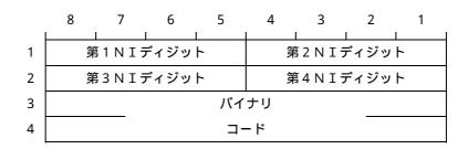
図3 - 13 / J T - Q 7 6 3 閉域接続インタロックコードパラメータフィールド (ITU-T Q.763)
