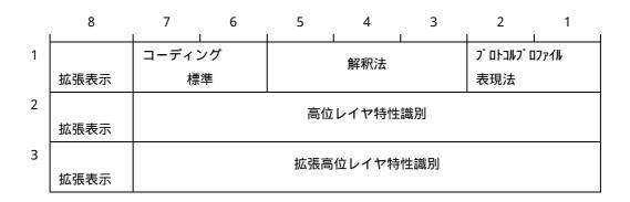
図3 - 5 2 / J T - Q 7 6 3 ユーザテレサービス情報パラメータフィールド (ITU-T Q.763)
