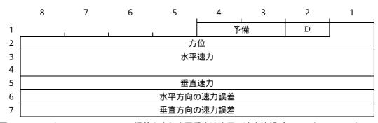
図3 - 1 1 2 d / J T - Q 7 6 3 誤差を含む水平垂直速度用の速度情報パラメータフィールド (ITU-T Q.1902.3)
