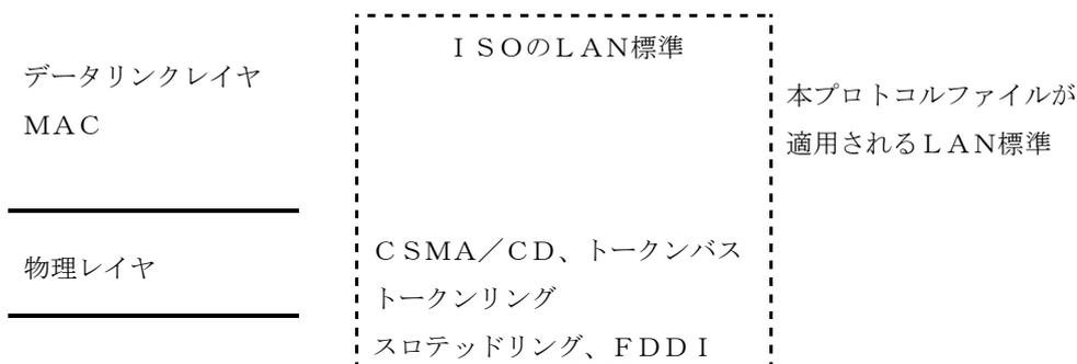
図7-1 / JS-8880-a コネクション型ネットワークサービスを提供するためのプロトコルプロファイルの規定範囲
