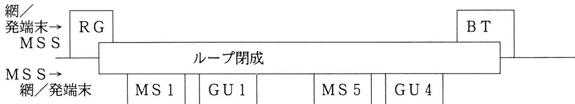
付図1-6/JJ-30.10 16 Hz呼出・MS 2なし・デフォルト端末未設置の場合の制御シーケンス
