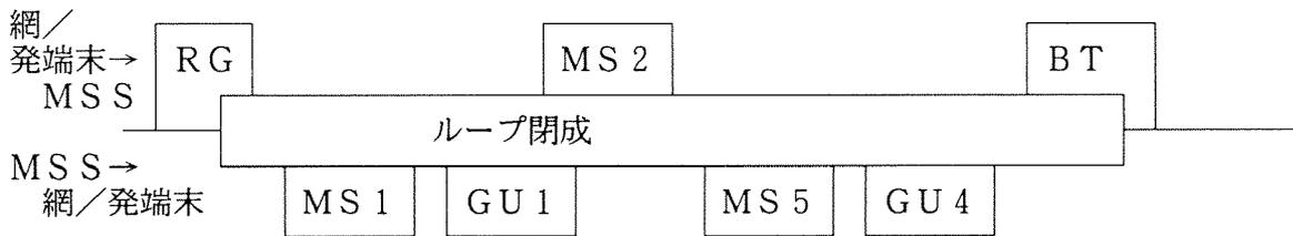
付図1-5/JJ-30.10 16 Hz呼出・MS 2受信・内線端末未設置の場合の制御シーケンス
