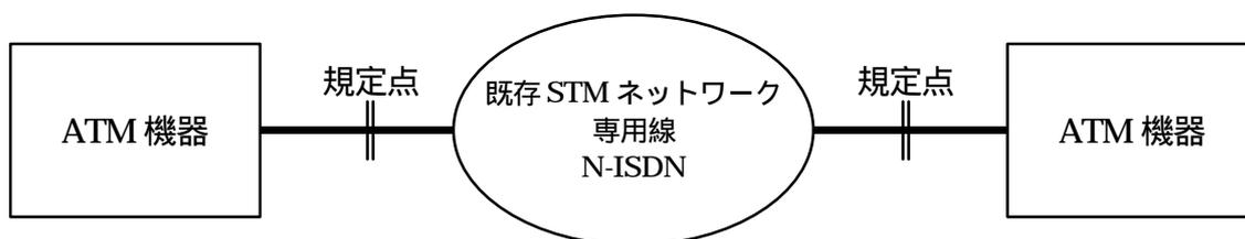
図1-1/JJ-20.81 インタフェースの参照モデル
