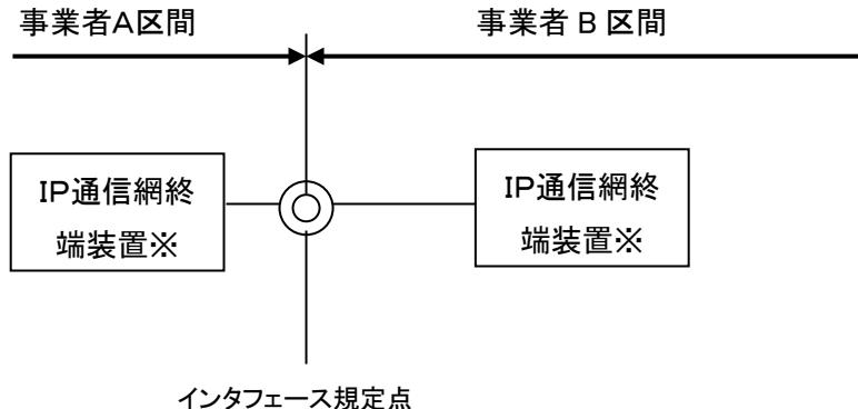
※ レイヤ1およびレイヤ2機能を用いて、情報転送および終端を実現可能な装置。
