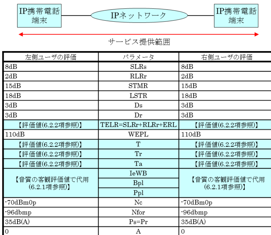
図 6-1 / JJ-201.11 <パラメータの設定例 (IP 携帯電話端末ユーザ同士の通話の場合)>
