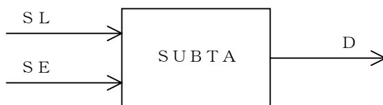
付図3-1/JT-G727 差分信号算出部 (ITU-T G.727)
