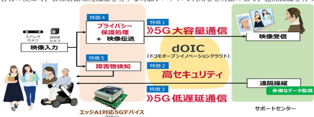
図3.5.2 リモート手助けにおける5Gシステム構成<sup>35</sup>
