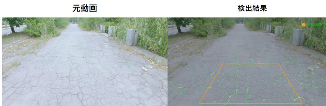
図3.5.4.3 路面のひび割れ検出例
