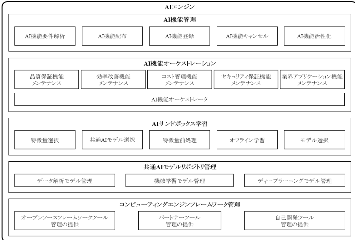
図 8-4-AITOM 内の AI エンジンのアーキテクチャ
