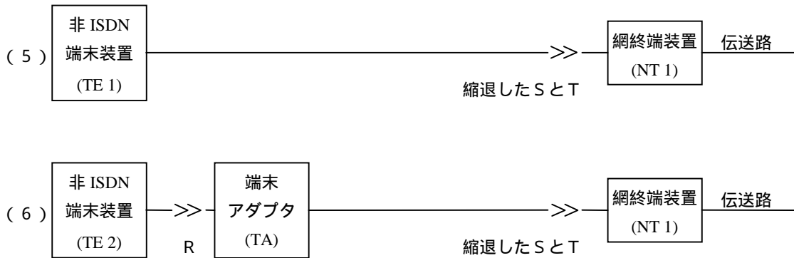
参照点TとSが縮退し、そこに1つのISDN物理インタフェースがある場合の実現形態
