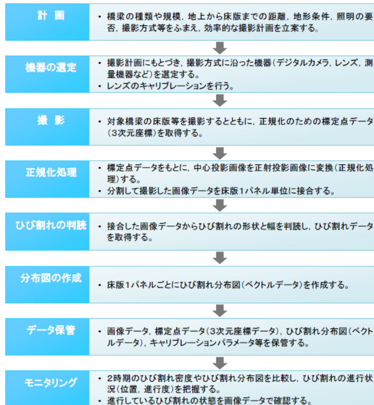
図4 画像によるひび割れモニタリングのプロセス (出典[7])
