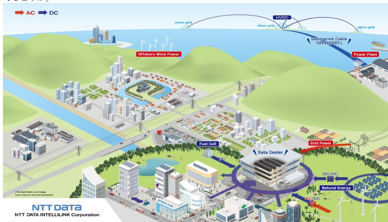
図 2.10-1 データセンターをエネルギー核とした直流マイクログリッド
