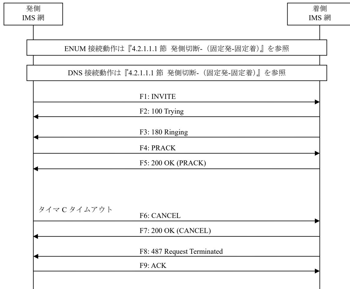
図 4.2.1.2.3-1/TR-1088 途中切断 (タイマ C 満了 発側切断)
