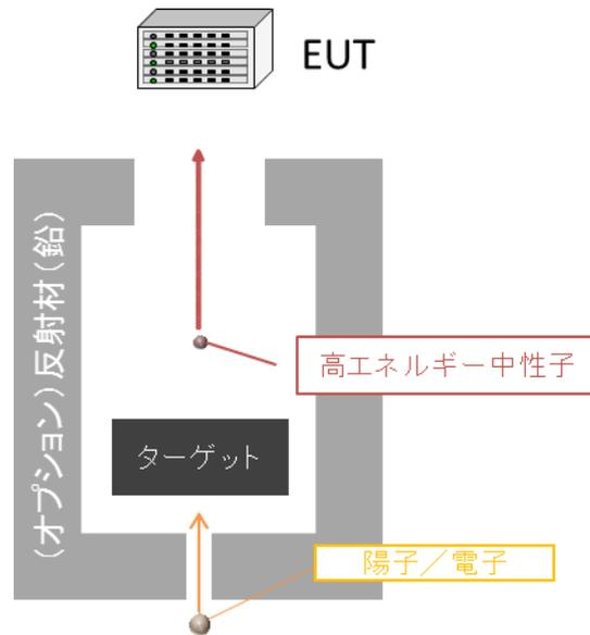
図 7.3 高エネルギー中性子用ターゲット組立構成
