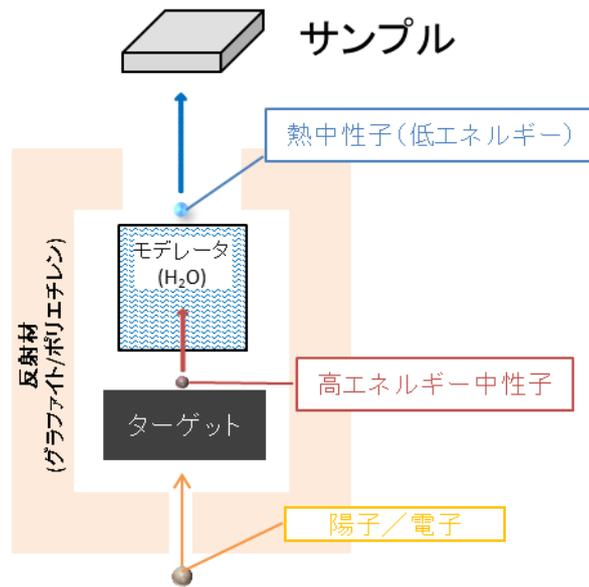
図 7.2 熱中性子用ターゲット組立構成
