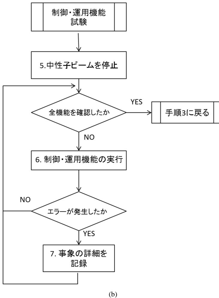
図 9.1 中性子照射試験のフローチャート
