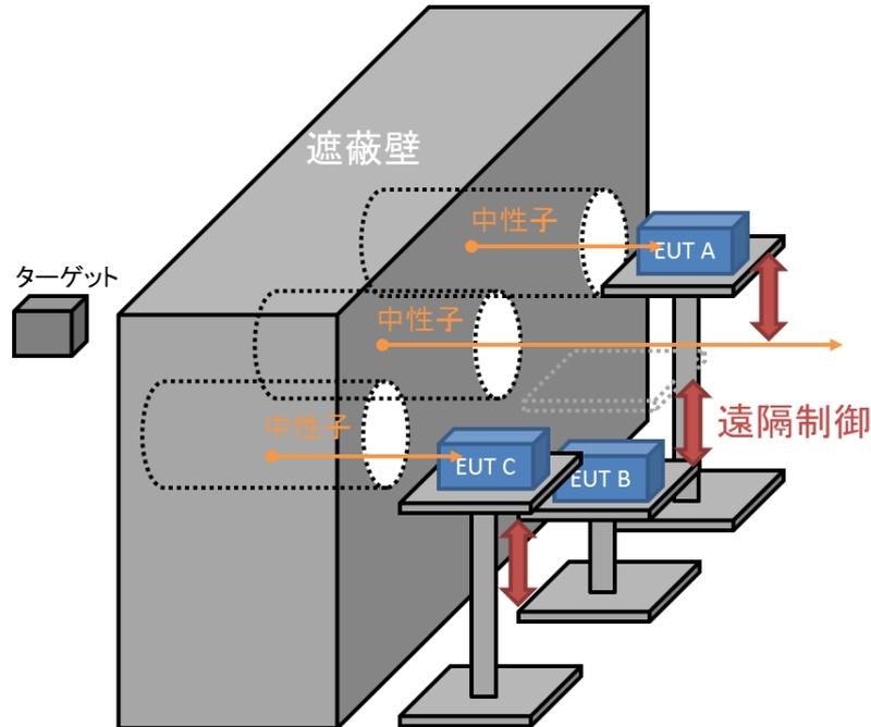
図 7.6 遠隔制御リフトを用いた複数 EUT への同時照射例
