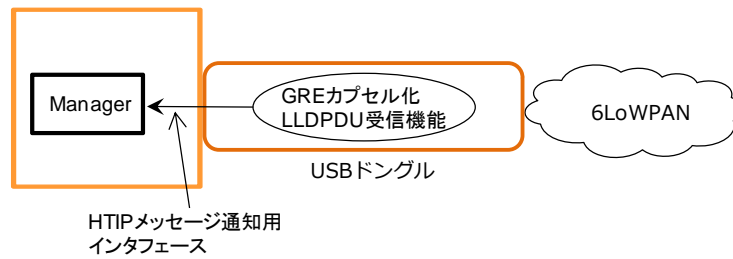
図2-7 ManagerがIP層以上も終端するUSB Dongルで非イーサネットデータリンク層と接続する場合の構成
